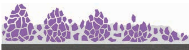
Samo brusilni efekt keramičnega zrna
