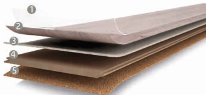
Naravna talna obloga Fibrano® je sestavljena iz petih dobro premišljenih plasti: premaza HotCoating (1), digitalnega potiska (2), udobnega sloja Fibrano® (3), plošče iz naravnih vlaken, ki zadržuje vlago, (4) in stisnjene podložne plute (5).
