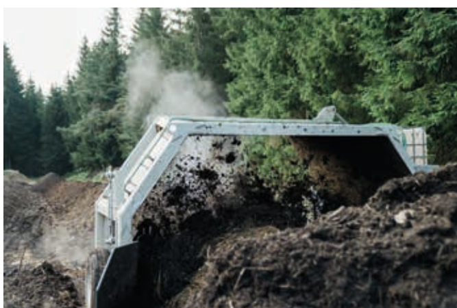
Obračalnik komposta je mogoče priključiti na traktor. Obračalnik meša, obrača in rahlja zemljo.
